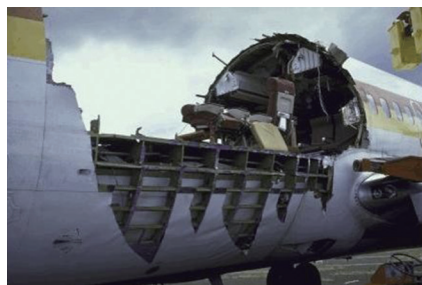
图1 飞机连接区域结构失效
